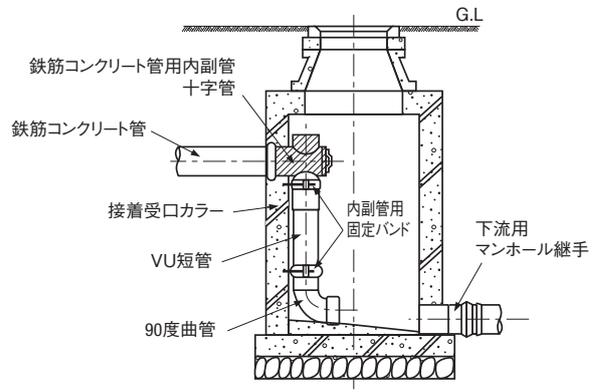
△ 注意 MRL-UC-Hの受口は図のようにマンホール壁内で接合し継手に荷重が加わらないように施工してください。
