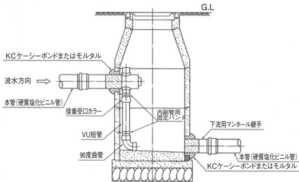
〈鉄筋コンクリート管用内副管の使用例〉
