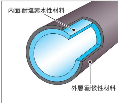
ポリニクス二層管は、内面に耐塩素水性材料、外面に耐候性材料を使用し、同時押出成形によって製造したパイプです。耐衝撃性、耐久性可とう性にすぐれ、柔軟性があり、施工性が良く、長尺管であるため継手接合箇所が少なく済みます。
