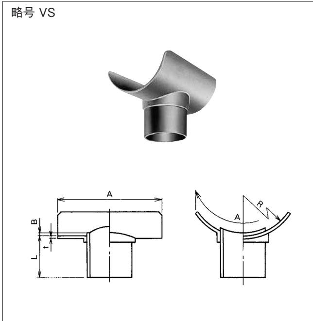
備考:(注1) 呼び径125×100のA寸法は、管軸方向255×円周方向220です。
