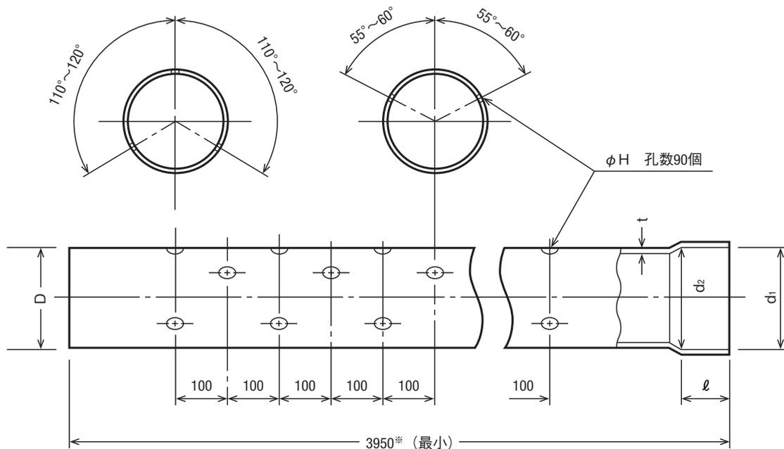
※有孔管は長さ4mの塩ビ原管を受口加工するため、加工による収縮等で長さが5~20mm程度短くなります。
